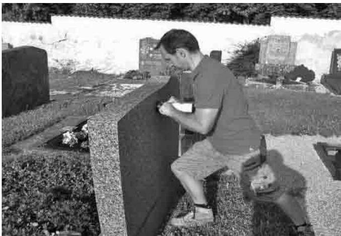
Am 08.7.2013 wurde auf dem Ihrlersteiner Friedhof die vorgeschriebene Standsicherheitsprüfung durch den Steinmetzmeister Herrn Horak mittels eines geeichten Druckprüfgerätes durchgeführt.
