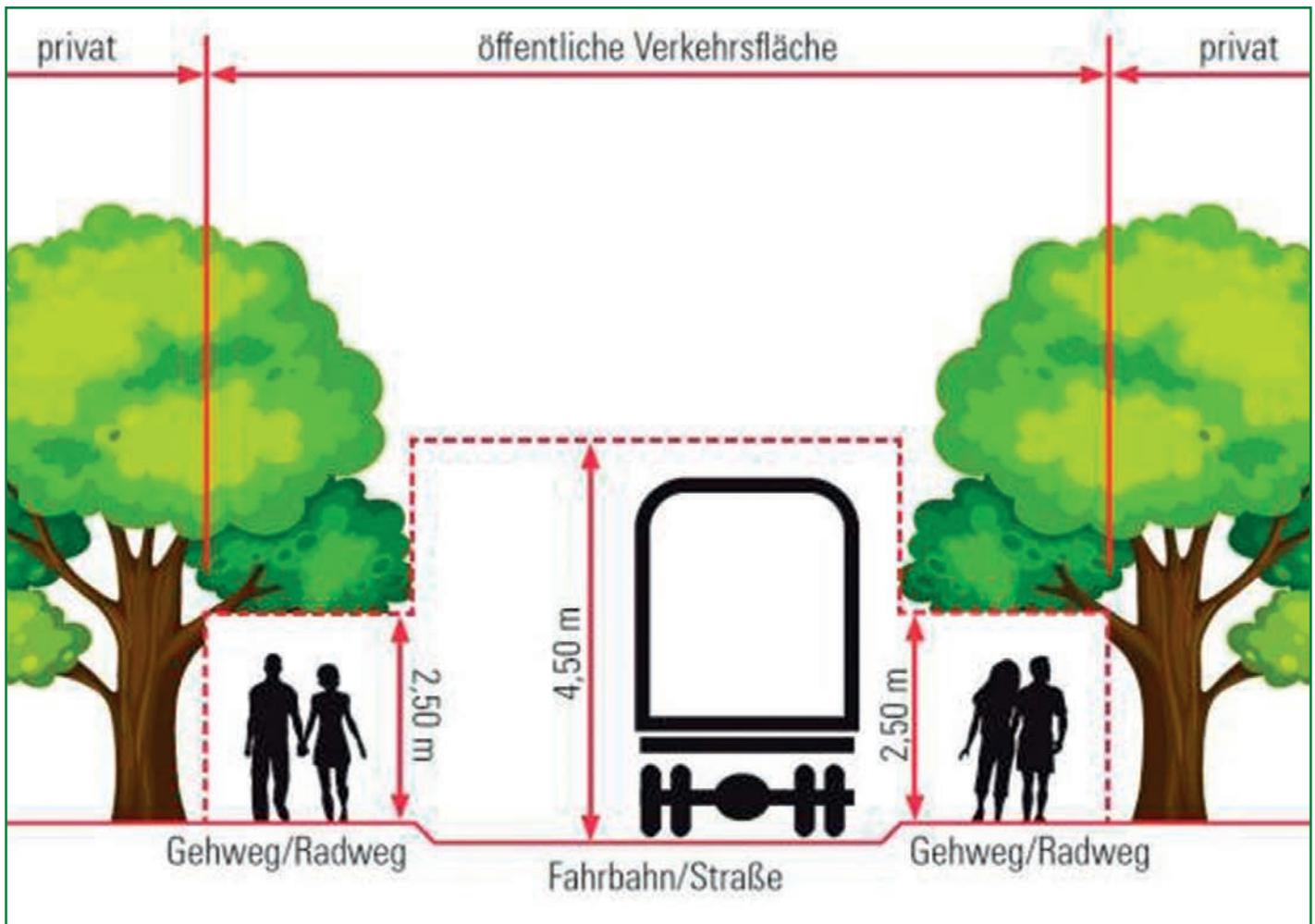
Als „Lichtraumprofil“ wird eine definierte Umgrenzungslinie bezeichnet, die meist für die senkrechte Querebene eines Fahrweges bestimmt wird. Aus Gründen der Sicherheit und Leichtigkeit des Verkehrs muss das Lichtraumprofil der öffentlichen Verkehrsflächen frei und sauber gehalten werden.
